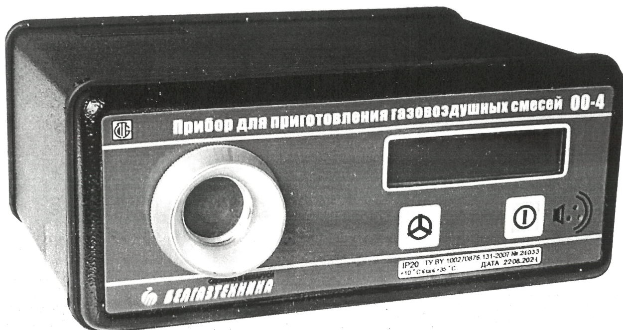
Рисунок 1.1 – Фотография общего вида и маркировки прибора для приготовления газоздушных смесей OO-4 (изображение носит иллюстративный характер)
