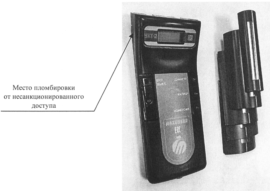
Рисунок 3.1 – Схема пломбировки от несанкционированного доступа
