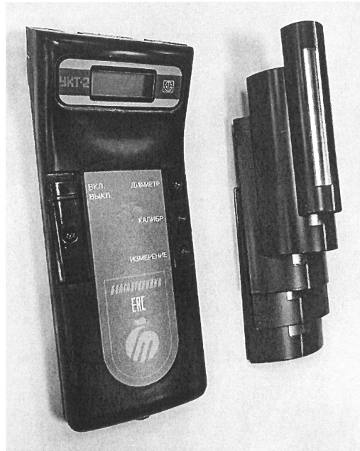
Рисунок 1.1 – Фотография общего вида устройства контроля толщины изоляции УКТ-2 (изображение носит иллюстративный характер)
