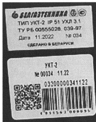
Рисунок 1.4 – Фотография маркировки устройства контроля толщины изоляции УКТ-2 (изображение носит иллюстративный характер)
