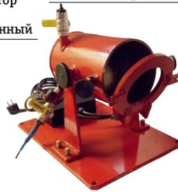
Камера демонстрационная взрывная ДВК-17
